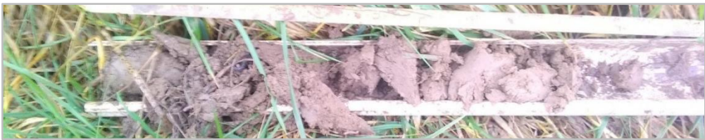
Photo 12 : Profil pédologique d'un FLUVIOSOL, faiblement brunifié, caillouteux et à texture limono-argileuse dominante (Sondage P398). Photo prise sur site @Rainette, 2024
