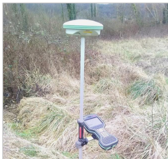
Photo 27 : Photographie du dispositif de mesure de coordonnées GPS de précision centimétrique (GPS GS07 et carnet CS20 de la marque Leica). Photo prise sur site, © Rainette, 2024
