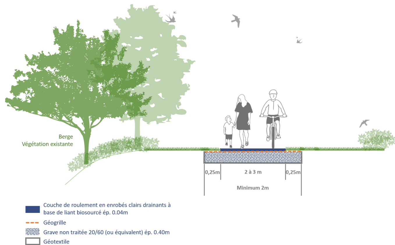
Figure 4 - A bis - Coupe type véloroute en site propre
