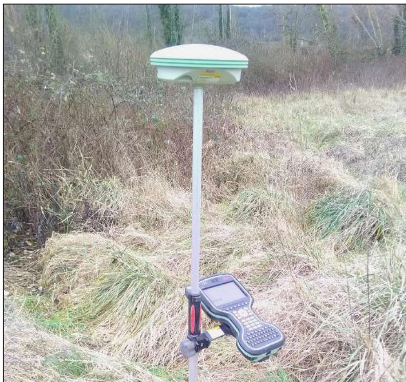
Photo 1 : Photographie du dispositif de mesure de coordonnées GPS de précision centimétrique (GPS GS07 et carnet CS20 de la marque Leica). Photo prise sur site, © Rainette, 2024
