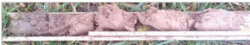
Photo 50 : Profil pédologique d'un BRUNISOL-REDOXISOL, à texture limoneuse dominante (Sondage P299). Photo prise sur site ©Rainette, 2024
