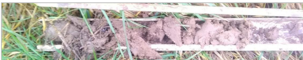
Photo 88 : Profil pédologique d'un FLUVIOSOL, faiblement brunifié, caillouteux et à texture limono-argileuse dominante (Sondage P398). Photo prise sur site ©Rainette, 2024
