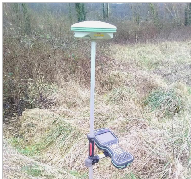
Photo 2 : Photographie du dispositif de mesure de coordonnées GPS de précision centimétrique (GPS GS07 et carnet CS20 de la marque Leica). Photo prise sur site, © Rainette, 2024
