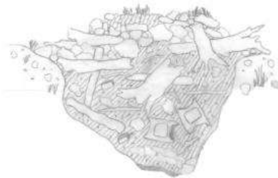
Figure 1 : Vue en coupe d’un hibernaculum présentant des interstices créés à l’aide de troncs et de branches d’arbres disposés transversalement, afin de faciliter l’accès à l’herpétofaune (Guide pour l’aménagement d’ouvrages en faveur de l’herpétofaune - septembre 2022 - BUFO).
