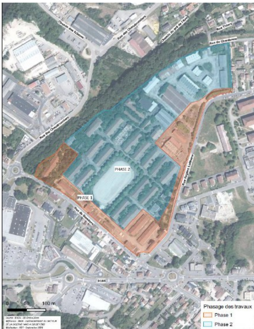
Figure 2 : localisation des phases de démolition
