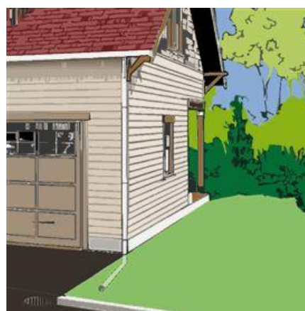
Pour corriger un branchement direct à la rue. Le tuyau souterrain peut être sectionné avant la limite du terrain. L'eau s'infiltrera dans le sol.
