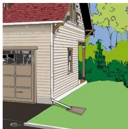
Utilisez un déflecteur. Cette solution permet d'éviter l'accumulation d'eau près de la fondation et dans le drain de fondation.
