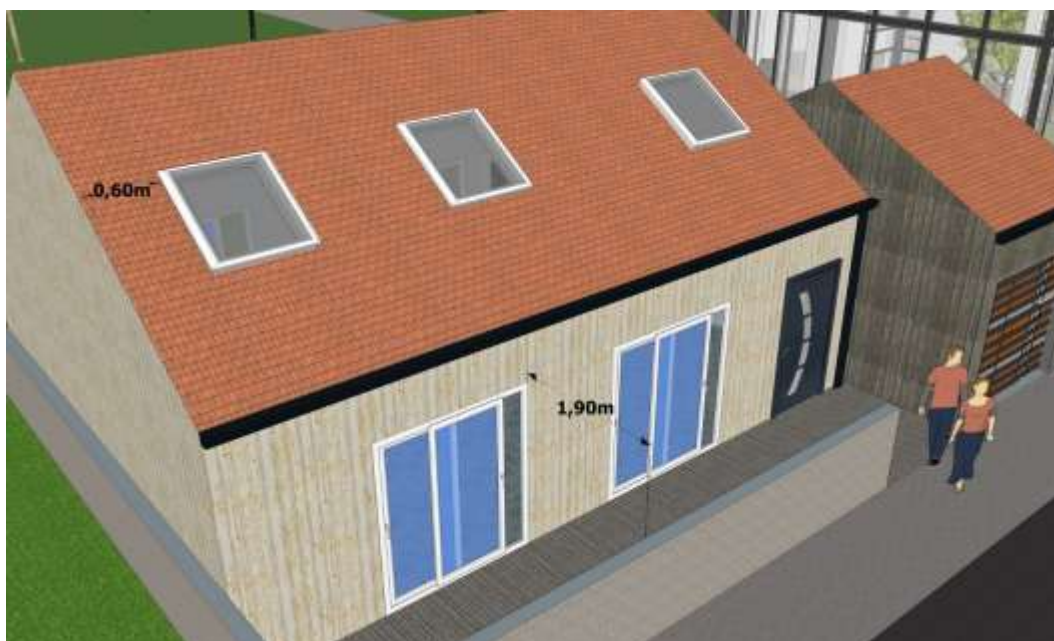
Le code civil impose un certain nombre de règles notamment sur les distances à respecter pour les ouvertures par rapport aux limites séparatives.
