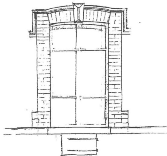
Appareillage de briques et pierres sur couronnement et appuis Fin du XIXe siècle
