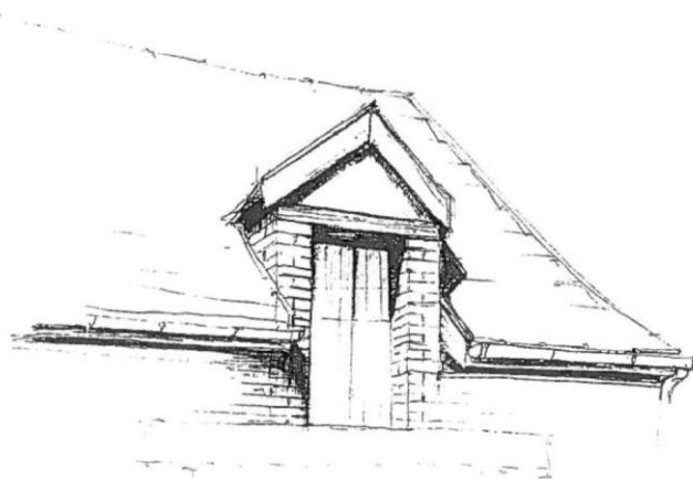
Lucarne en surcroît formant tympan. Appareillage de briques et pierres sur couronnement Fin du XIXe siècle
