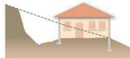
Plate-forme en déblais
