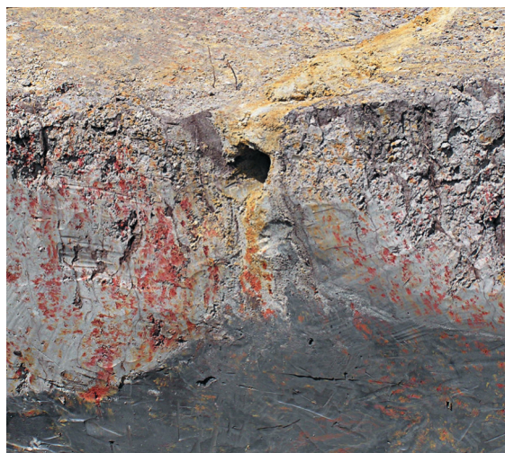
Figure 3 Hétérogénéité des terrains sur le site de Pessac (Source I2M-GCE, université de Bordeaux)
