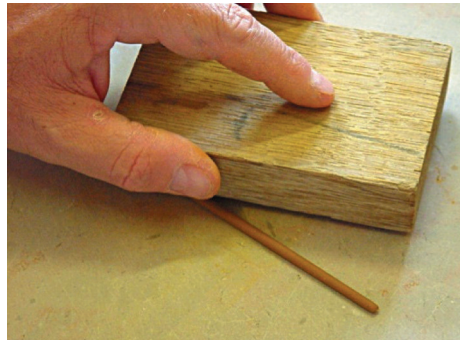
Essai de détermination de w_p ( w > w_p au moment de la photographie)
