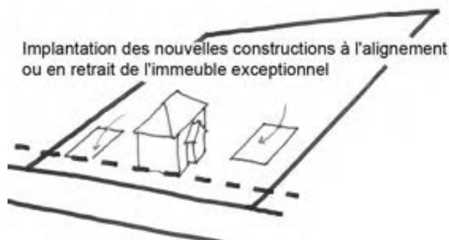
Fig 1 : Les nouvelles constructions situées sur l'emprise de la parcelle d'un bâtiment exceptionnel ou à préserver se situeront à l'alignement ou à l'arrière de ce bâti, ce par rapport à la façade principale de l'immeuble
