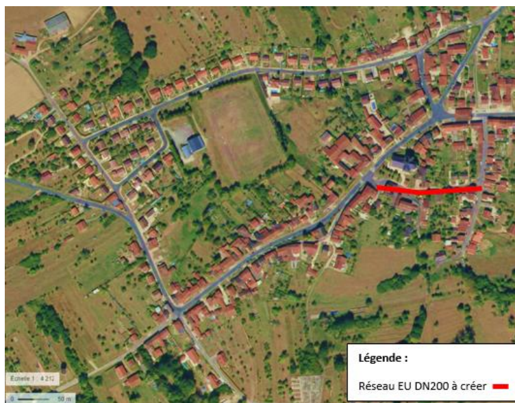
Figure 34 Travaux à mener pour la mise en séparatif de la rue Le Prêtre
