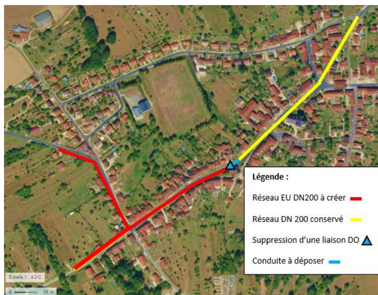
Figure 31 Travaux à mener pour la mise en séparatif des rues du BVUNC01
