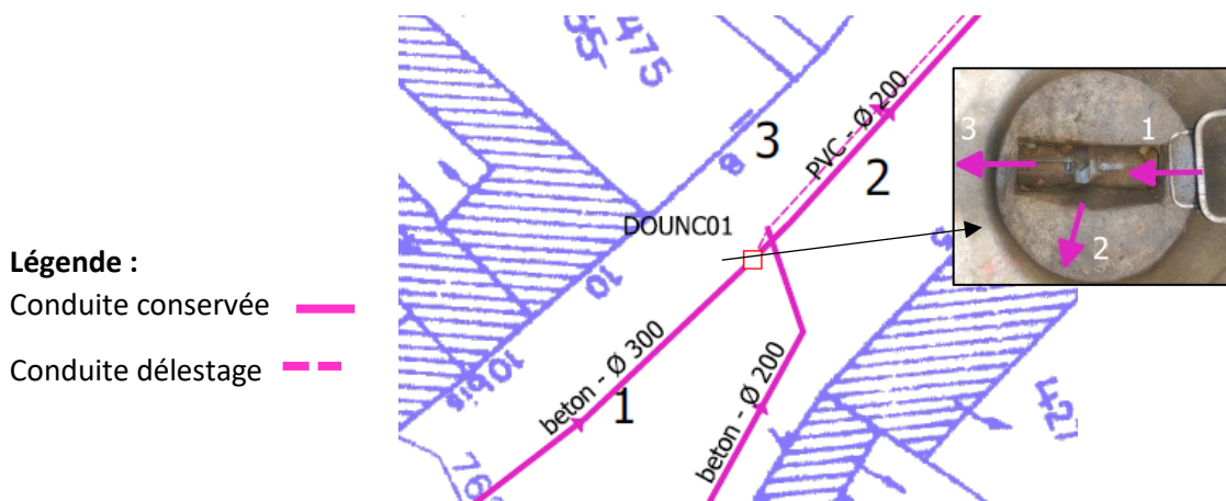
Figure 20 Délestage au niveau de la rue Haute – Source : Etude ARTELIA
