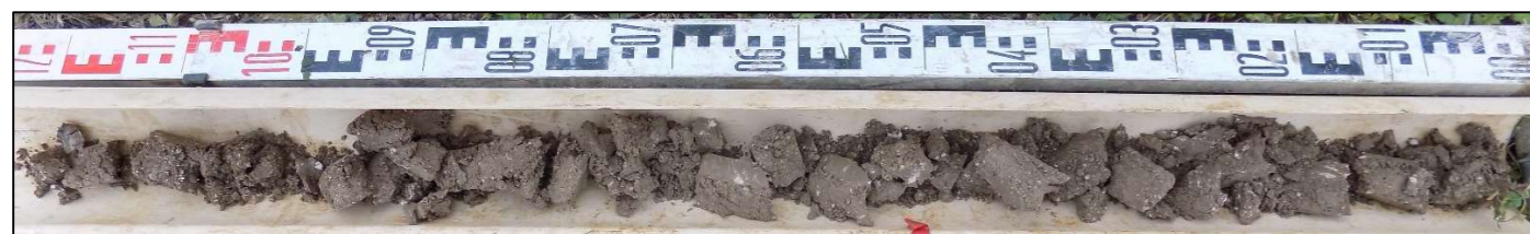
Figure 22 : Profil typique de cette unité de sol (photographie du sondage S1)
