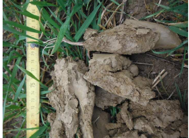
Figure 12 : sol verdâtre en profondeur avec tâche de rouille en abondance
