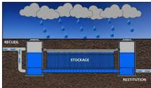
Exemple de bassin enterré
