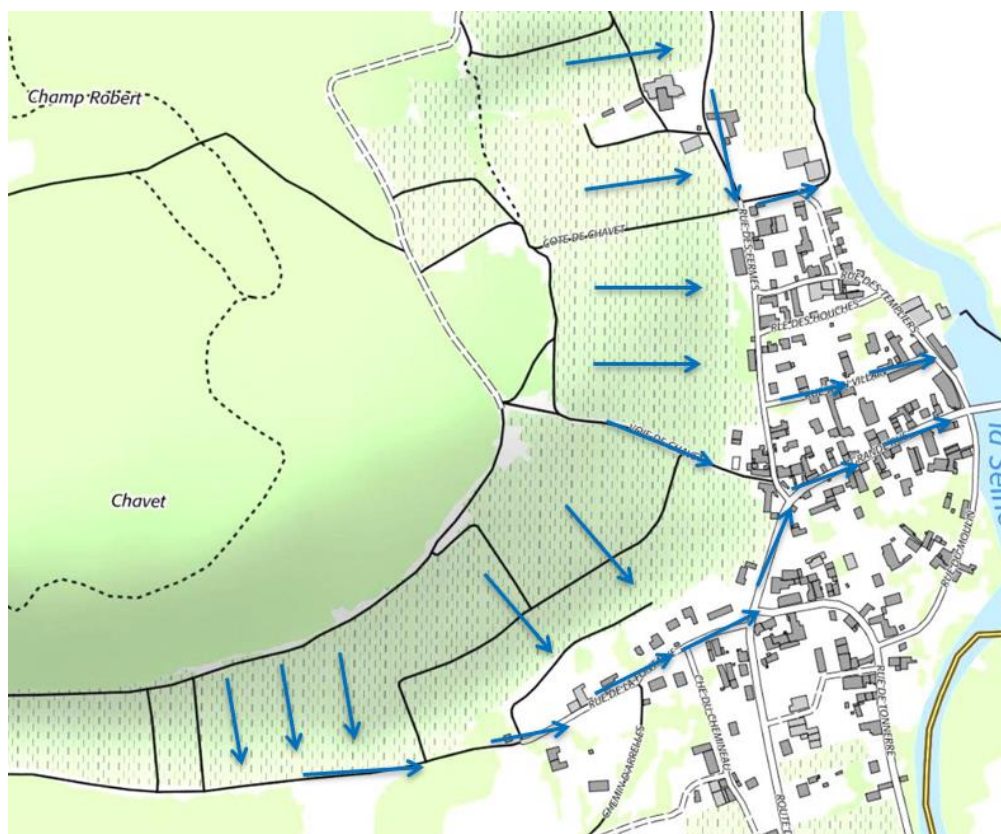
Localisation des phénomènes de ruissellement
