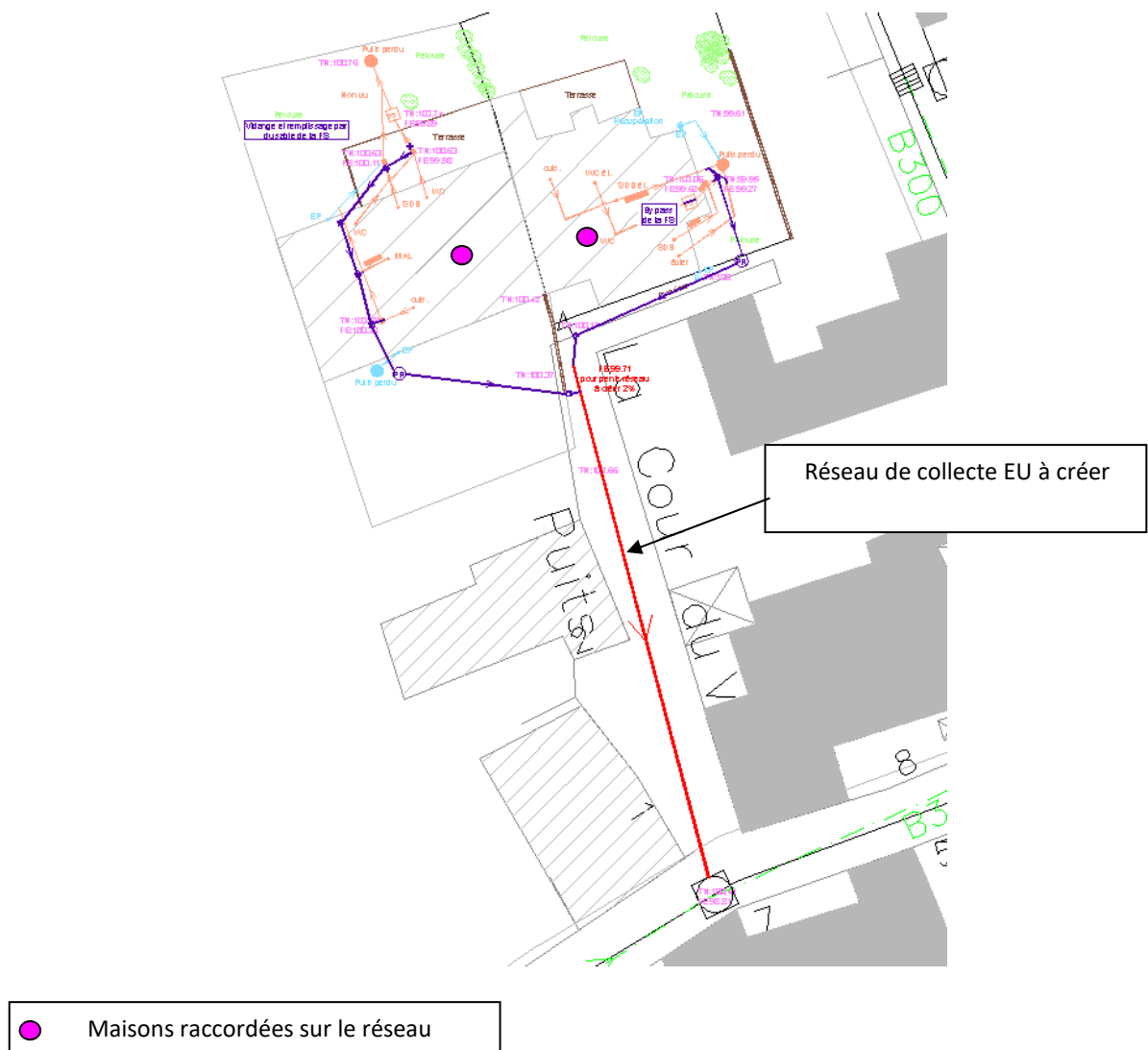
Figure 34 : Travaux de création de réseau Cour du Vieux Puits
